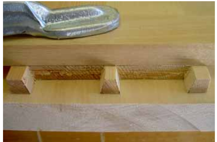
22. Tappikappale on valmis. Huomaa, että puun sisällä olevia pieniä epätasaisuuksia ei kannata turhaan viimeistellä; ne eivät tule jäämään näkyviin.
