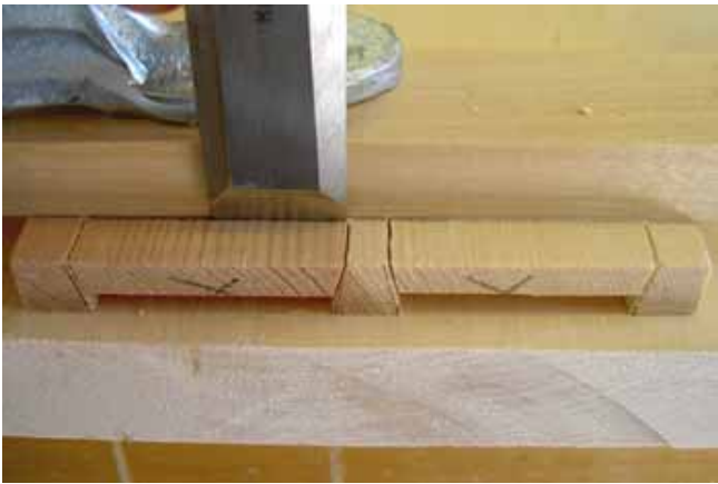
18. Talttaa toiselta puolelta samalla tavalla, mutta älä lyö puunuijalla talttaa liian raskaasti, jotta pala puuta ei irtoaisi ensimmäisellä lyönnillä.
