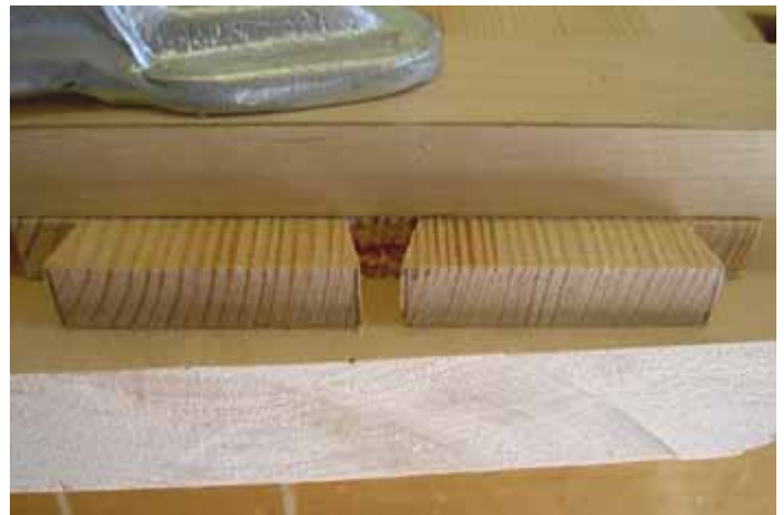
34. Lovikappale alkaa olla valmis ja liitosta päästää kohta sovittamaan.
