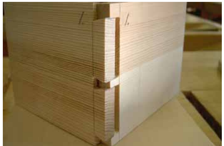
35. Sovita liitosta paikalleen ja varmista, että se ei ole liian tiukka. Tappeja voi tarvittaessa vielä hieman veistää terävällä puukolla joko tappi- tai lovikappaleesta, mutta liian väljää liitosta on hankalampi korjata. Väljässä liitoksessa tappikappaleeseen voi yrittää liimata samanlaisesta puusta tehdyn sopivan tikun liitosta kasattaessa.
