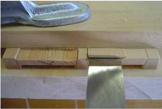
19. Etene vaiheittain ja poista vain pieni pala puuta yhdellä kerralla.
