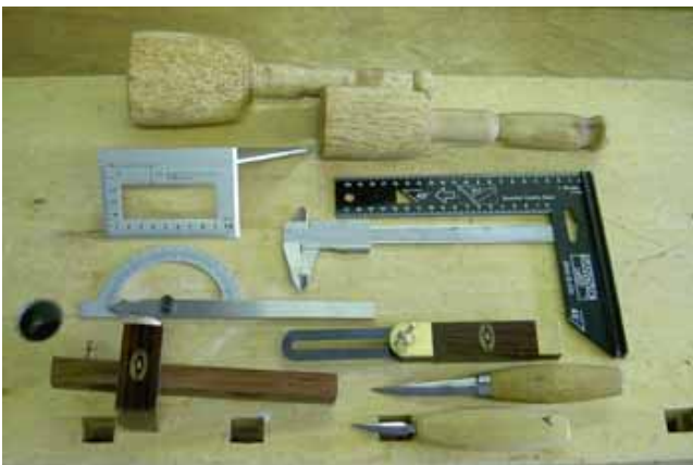
38. Tässä kuvassa on lisäksi muutamia työvälineitä, joista voi olla hyötyä muita liitoksia valmistettaessa esim. kapeateräiset puukot, työntömitta sekä aste- ja kulmamitta.
